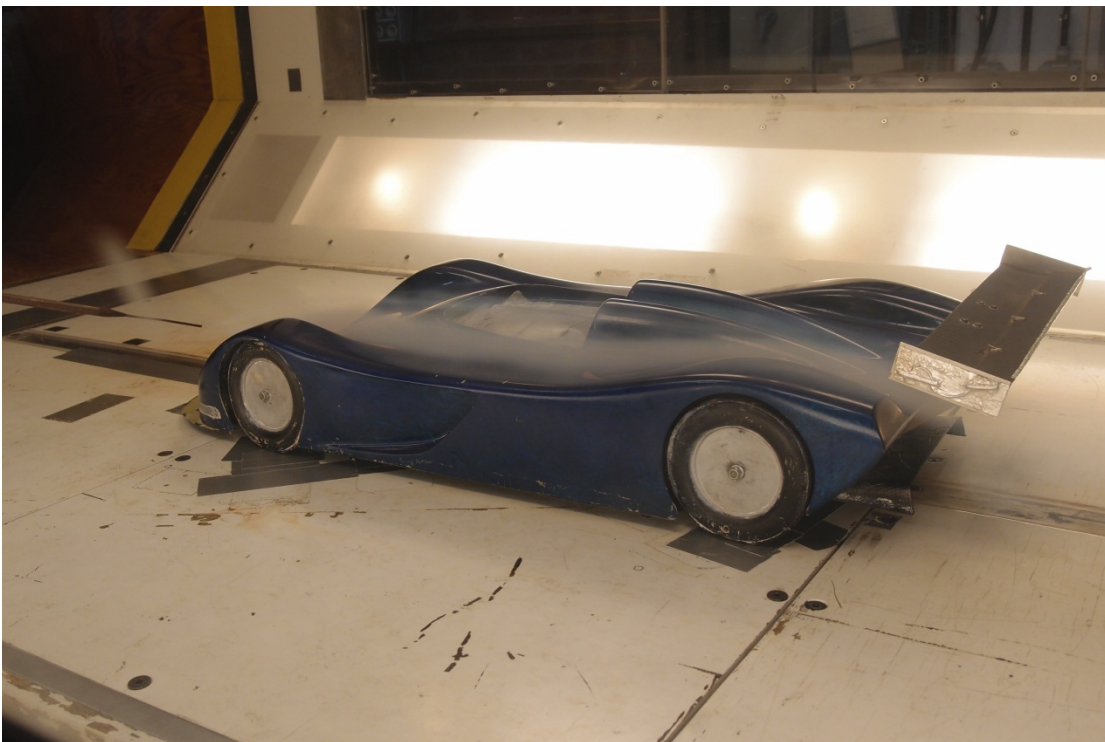
在風洞中實測模型
