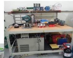
直接冷卻壓電式散熱系統
