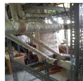
微通道熱沉冷凝測試設備
