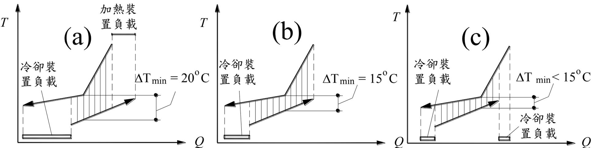
如圖12-20(a)的複合負載曲線，假設其原先的 $\Delta T_{min} = 20^\circ\text{C}$ ，原有的設計各需要冷源與熱源；若我們將此一複合負載曲線的冷流向左平移，顯然的 $\Delta T_{min}$ 會逐漸縮小，而冷側所需要的熱源也跟著縮小；假設當 $\Delta T_{min} = 15^\circ\text{C}$ 時，冷流端點與熱流端點到達同一位置(即冷流端無須藉用加熱裝置熱源)，此時就到了一個臨界設計點(threshold design)， $\Delta T_{threshold}$ 當冷流持續向左移動越過臨界點，雖然冷側不需要熱源，卻造成熱流側的兩端同時需要冷源來冷卻，而且此一冷源的冷卻量則維持固定(如圖12-21)，不會因為 $\Delta T_{min}$ 縮小而持續降低，也就是說無法持續降低冷源的使用量；但是因為 $\Delta T_{min}$ 縮小後反而會造成熱交換器變大，更何況冷源的冷卻量並不會持續縮小，因此設計在此臨界點後並無實質的幫忙與意義。
