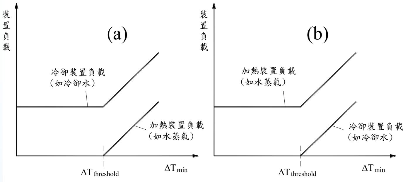
通常我們對 $\Delta T_{min}$  都有一個預估的經驗值，即 $\Delta T_{min,exp}$ ；如果 $\Delta T_{threshold} \gg \Delta T_{min,exp}$ ，在這個條件下，冷流與熱流負載曲線岔的相當的開，如前所說明，使用 $\Delta T_{min,exp}$  設計將無實質的幫助，因此設計上可以 $\Delta T_{threshold}$  當做設計點，其設計步驟可說明如下：
