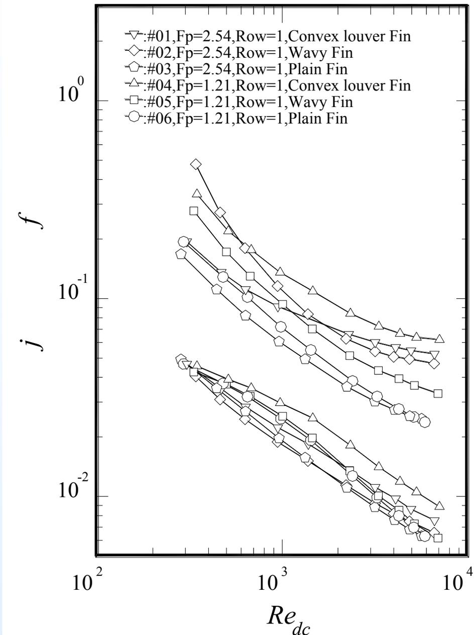
圖7-7 複合式百葉窗片 (convex-louver)、波浪鰭片 (wavy) 與平板型鰭片 (plain) 的性能直接評價
