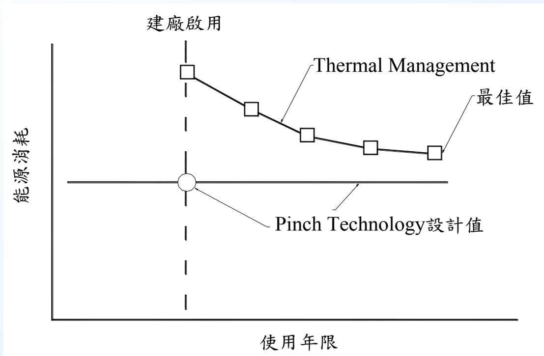
Thermal management 是藉由建廠後長期的監控與查核，再逐步地去調整與改善耗能與沒效率的設計(如圖所示)，透過系統監控與能源查核，沒有效率的能源耗費得以逐步改善
